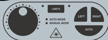
スピードダイヤルを8に合わせる。LEFTボタンを押し、トロリーを左端まで移動させる。一旦OMCの方向を変更すると作動準備が完了する。毎回起動時に行ってください。
